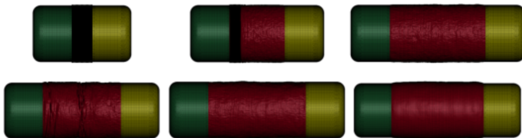
图 3 刚柔混合太空舱充气展开过程仿真结果
