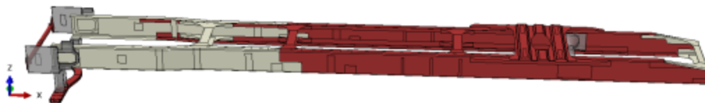
(a) 钢铝混合车架初始材料分布
